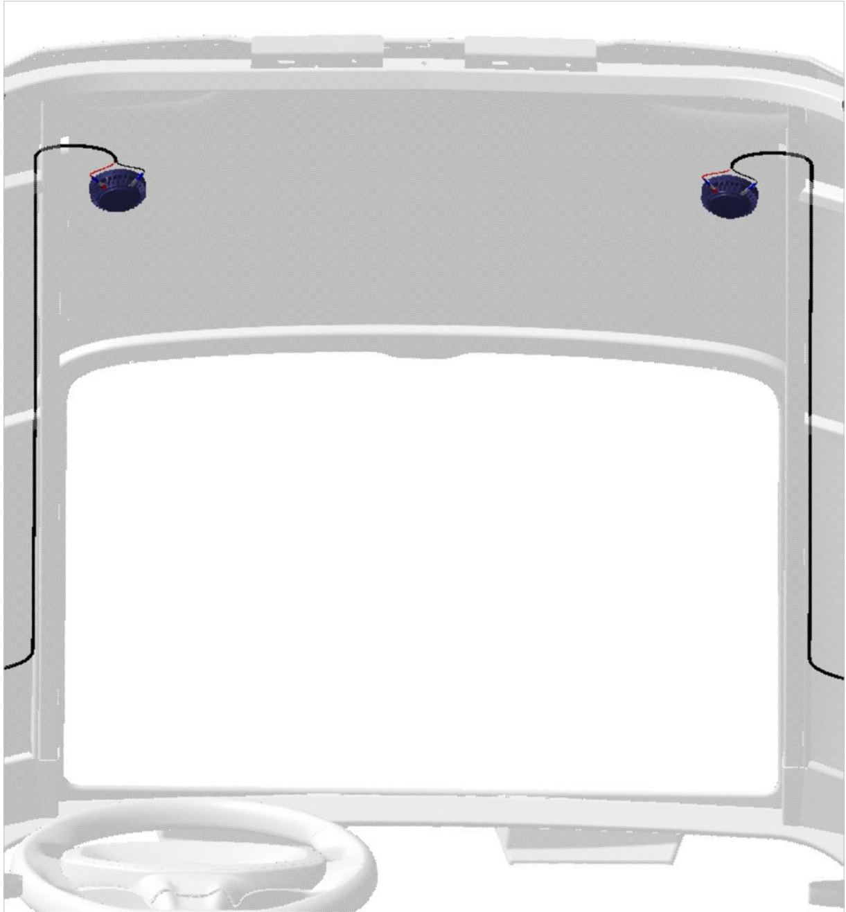
Vue du dessous du pavillon du véhicule avec les deux actionneurs installés.
